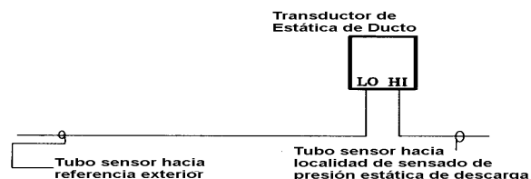
Esquemático de Tubería del Transductor de Presión de Ducto
